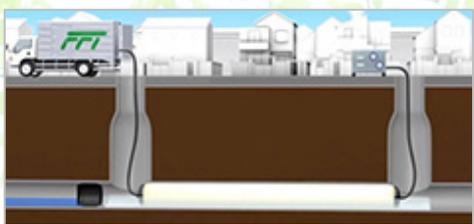
当社で現在認可されている工法、管全体を被覆するFFT-S工法と、部分的に補修するASS工法の2工法を用いて
