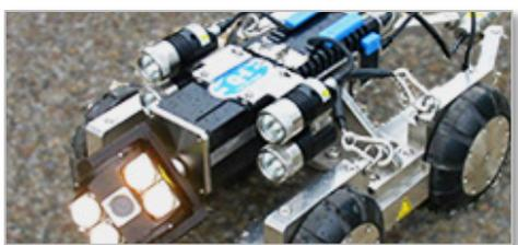
特殊なロボットカメラにより、管の中の亀裂や漏水・さまざまな付着物等を発見し、管の中のあらゆるトラブル箇所について撮影する事ができます。
